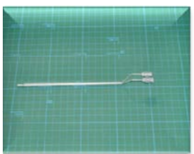
SUS304丸管材 1.0×R1.5 SUS304 round pipe
