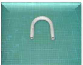
アルミ合金60系丸管材 22.0 × t1.8 × R60 Aluminum alloy(60 series) round pipe
