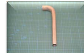
STKM楕円管材 41 \times 25 \times t3.0 \times Ri30 STKM ellipse pipe
