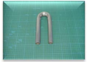
SUS304丸管材 22.0×t1.5×R35 SUS304 round pipe
