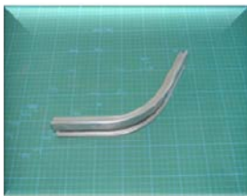
SUS304異型材 51×17×t1.2×Ri70 SUS304 pipe
