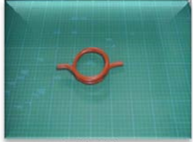
STB丸管材 10.5 × t2.5 × R40 STB round pipe
