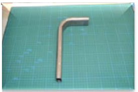
STKM楕円管材 46 \times 20 \times t2.0 \times R60 STKM ellipse pipe
