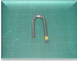
SUS304丸管材 19.0×t1.0×R38 SUS304 round pipe
