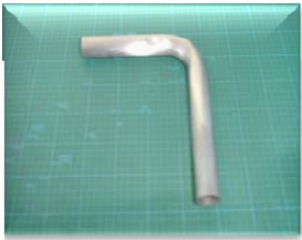
SUS304丸管材 34.0×t1.5×R50 SUS304 round pipe
