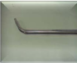
SUS304異型材 35×18×t1.5×Ri70 SUS304 pipe
