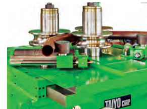
パイプ曲げ Bending pipe
