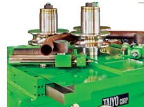
パイプ曲げ Bending pipe
